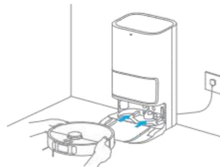
Nota: Si consiglia di ricaricare completamente il robot prima del primo uso. Quando il robot non può essere acceso dopo che la batteria è esaurita, collega manualmente il robot alla stazione per ricaricarlo.
