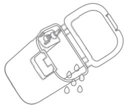
2. Sciacqua il serbatoio dell'acqua usata con acqua pulita e usa la spazzola per la pulizia fornito per pulire la parete interna del serbatoio dell'acqua usata.
